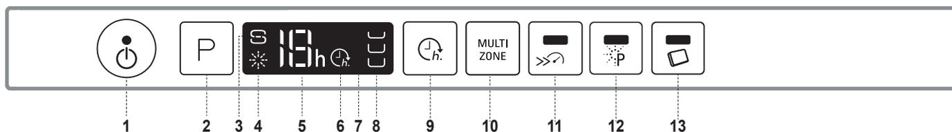
1. Ein-Aus/Reset Taste mit Anzeigelicht
